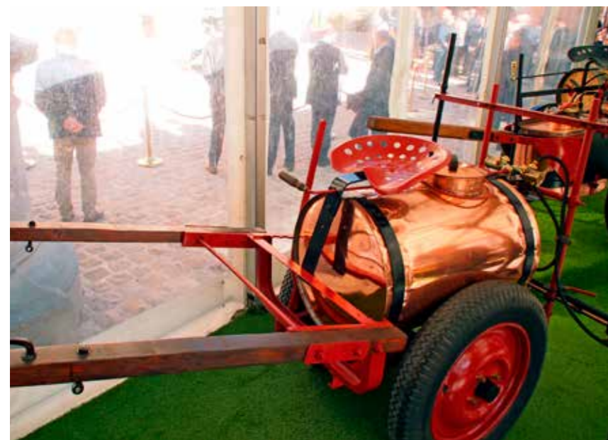
Pulvérisateur grandes cultures Vermorel à traction animale. La pompe est entraînée par les roues. Rampes latérales verticales à jets.
