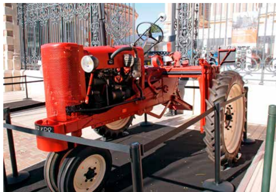
Conçu par Vincent Ballu, ce prototype de tracteur enjambeur fut essayé en 1947 dans les vignes de Moët & Chandon. L'engin pèse 2,1 t et mesure 2,20 m de hauteur. C'est ce modèle au confort limité qui est à l'origine de l'entreprise.
