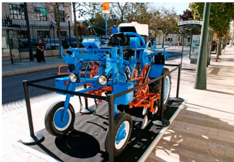
Enjambeur Derot-Tecnoma de 1970. Il est animé par un moteur Renault (le même que celui de la Dauphine). Ce tracteur porte-outil est destiné aux vignes étroites. Il est très agile dans les coteaux abrupts.
