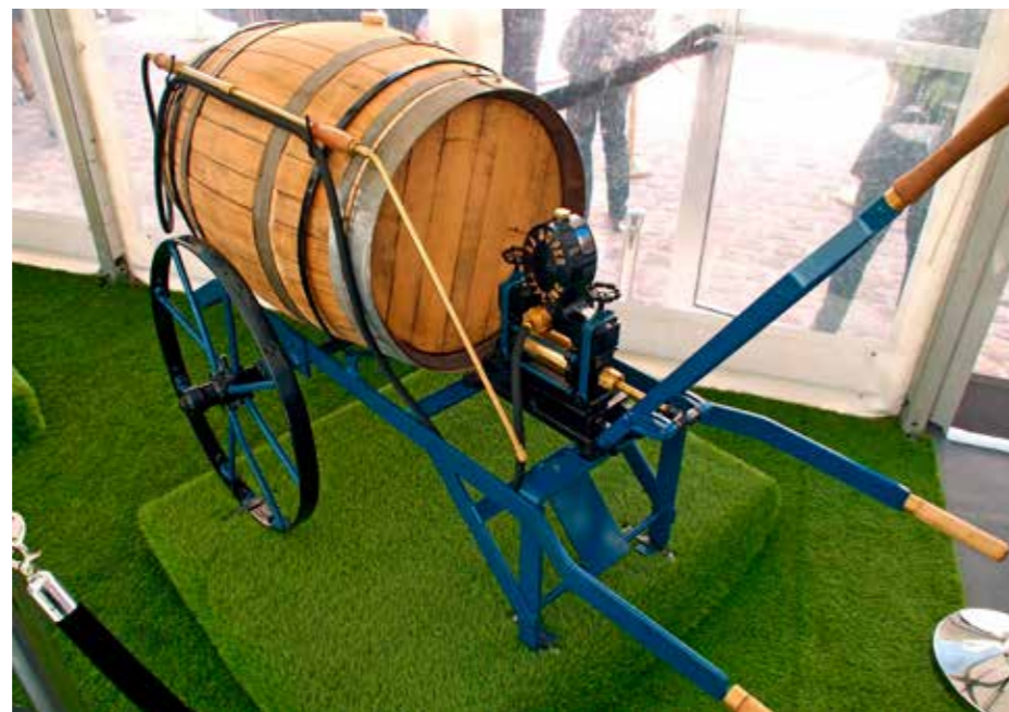
Pulvérisateur arboricole Caruelle à traction humaine, fabriqué avant la Seconde Guerre mondiale. Pompe à pression à bras et lance d'aspersion.
