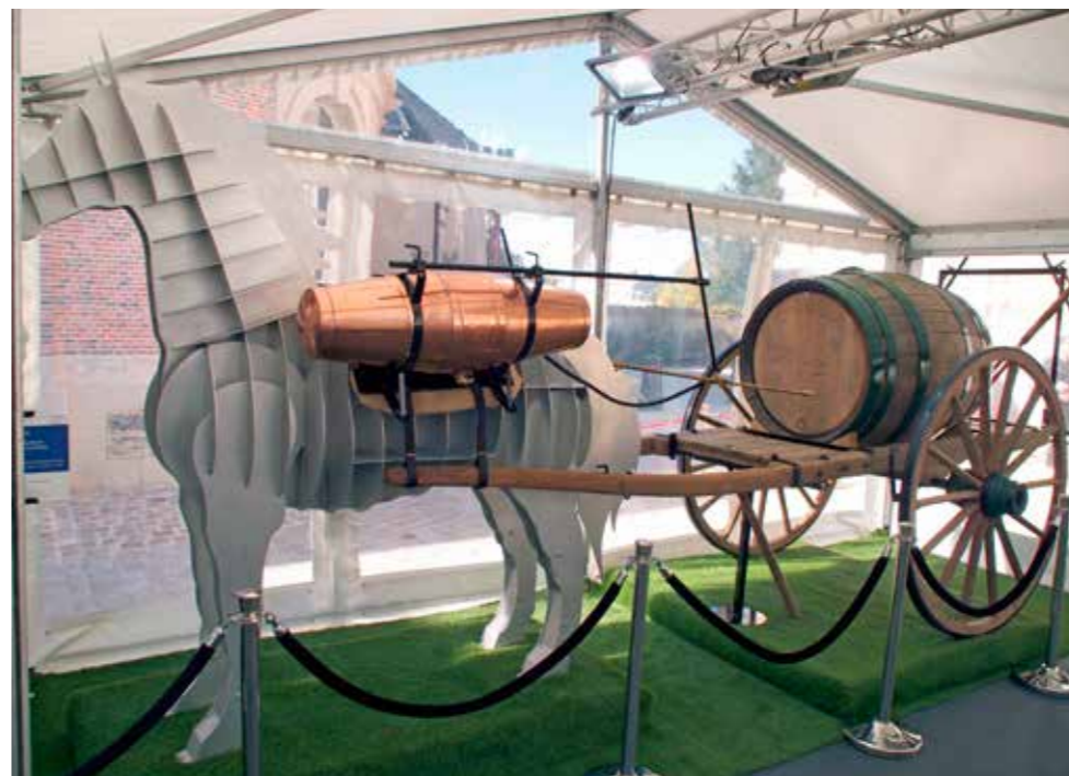
Un ensemble issu des années 1920-1930. À l'arrière, un pulvérisateur grandes cultures à traction animale Caruelle, avec chariot à structure bois et rampe repliable de 4 à 5 m. Sur le dos du cheval, un Berthoud Tango avec ses deux réservoirs en cuivre (rampe horizontale à jets).
